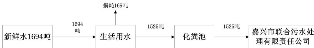
图 3-3 全厂水平衡图
